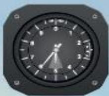
Instrumento de medición que indica la diferencia de altitud entre el punto donde se encuentra localizado y un punto de referencia; habitualmente se utiliza para conocer la altura a la que se encuentra un punto sobre el nivel del mar.
