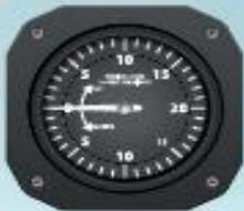
Indica si el avión está ascendiendo, descendiendo o va nivelado, y la velocidad vertical respectiva. Si la manecilla indica cero, el vuelo está nivelado.
